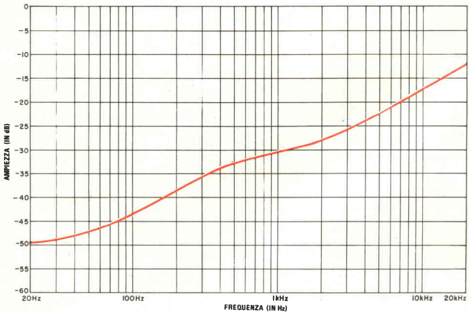
Fig. 3 - Risposta di preaccentuazione RIAA. Il circuito produce un'approssimazione vicina alla curva normalizzata RIAA.
